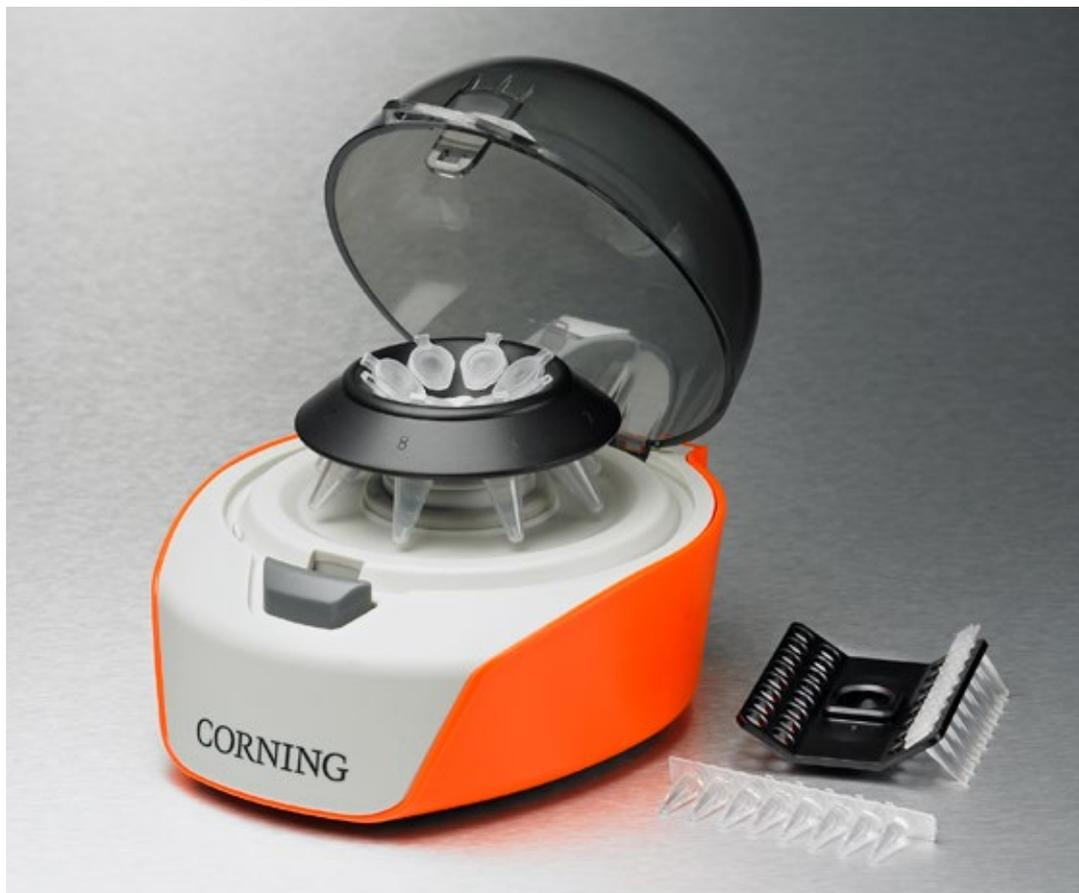
Corning LSE 卓上小型遠心機は、6,000 rpm (2,000 x g) の一定の速度で動作し、微量サンプルを手元で素早くスピンドウンできるようデザインされています。クイックリリースローターシステムや電動ブレーキなどの設計により、操作をよりシンプルに、より簡便に行うことができます。サンプルをセットし蓋を閉めるとすぐにローターが6,000 rpmまで速やかに加速します。この速度範囲は、マイクロフィルトレーションや一般的な分離操作に適しています。蓋のリリースボタンを押すと電動ブレーキが作動し、ローターが速やかに停止します。Corning LSE 卓上小型遠心機は、マイクロチューブ8本、または8連PCRストリップチューブ4本を一度に処理できます。また、付属のチューブアダプターを使用することで、0.2 mL、0.25 mL、0.5 mLなどの少量サンプルチューブにも対応可能です。
