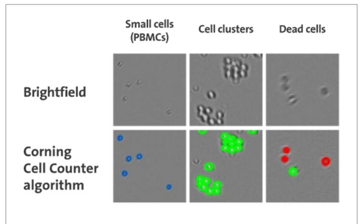
図3. アルゴリズムで処理された画像。行は明視野画像とCorning セルカウンターの解析画像を表す。列(左から右)はそれぞれ、小さい細胞、クラスター、死細胞を含むサンプルを示す。
