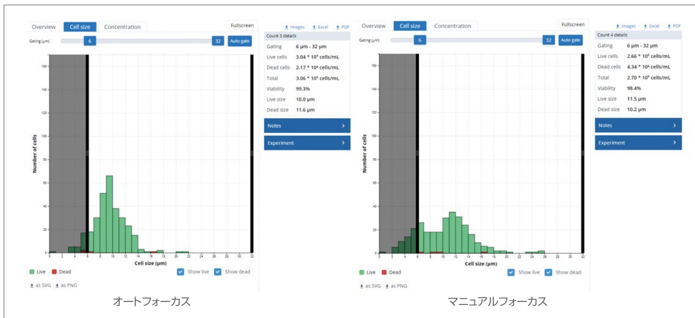
図 2. 細胞径を 6 \mu\text{m} にゲーティングしたヒストグラム (Vero 細胞)。この閾値を下回る細胞はカウントから除外される。死細胞 (赤いバー) と生細胞 (緑のバー) を切り替えて、各部分集団を別々に計測することも可能。
