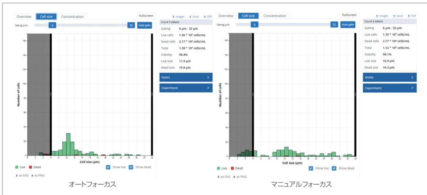
図 5. 細胞径を 6 μm にゲーティングしたヒストグラム (MSC)。この閾値を下回る細胞はカウントから除外される。死細胞 (赤いバー) と生細胞 (緑のバー) を切り替えて、各部分集団を別々に計測することも可能。
