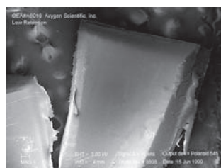
図1 Axygenマキシマムリカバリーチップの内側表面。倍率を最大にした場合でも表面は非常に平滑であり、サンプルの残留や変性の原因となるような隙間や空洞は見られません。
