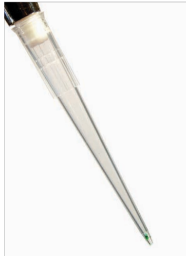
100 µLのサンプルを排出した後のマキシマムリカバリーチップ
