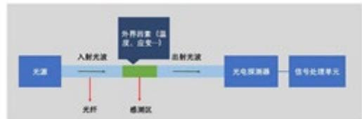
图2 光纤传感基本工作原理图
