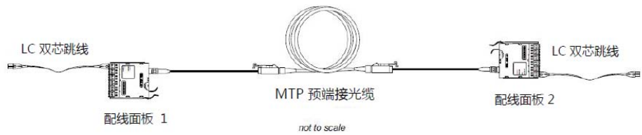
图 1：1 根光缆（2 个配线面板）链路设定
