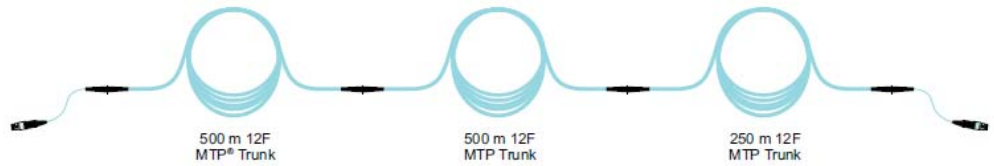
图 5：实验测试中运用的光缆配置 MTP Trunk：MTP 主干
