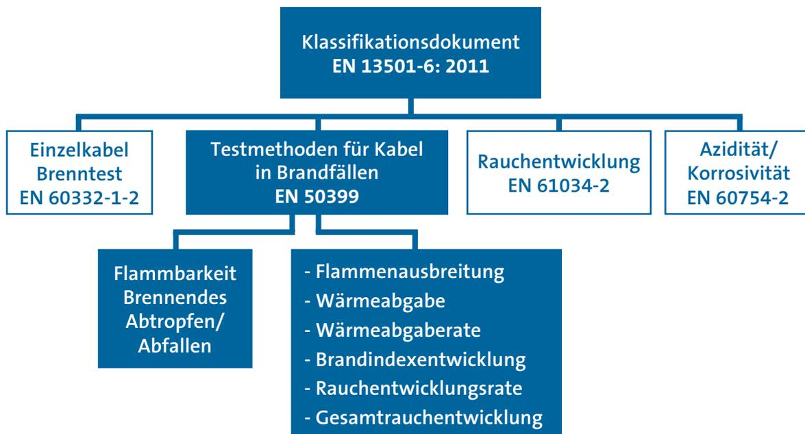
Die Grafik oben zeigt keinen Test für Kabelbündel. Die Tests gemäß EN 50399 werden jedoch für Kabelbündel durchgeführt. Folgende Übersicht erläutert, was die einzelnen Standards messen:
