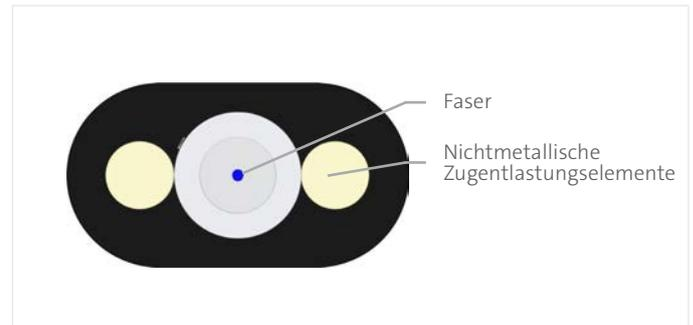
Als Branchenführer bei optischen Steckverbindungen, entwickelt und fertigt Corning die SST-Drop™ Kabelkonfektion mit werkseitig konfektionierten, umweltverträglich versiegelten und speziell geschützten Steckern. Dies reduziert die Kosten und den Zeitaufwand für den Einsatz von Drop-Kabeln in optischen Zugangsnetzwerken. Die Pushlok™ Dropkabel-Konfektionierung wurde speziell entwickelt, um die Installation erheblich zu vereinfachen.
