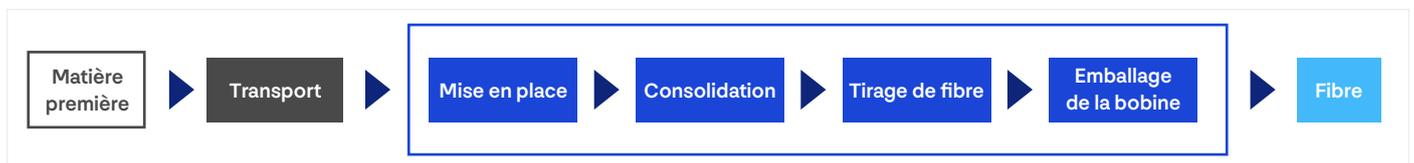
Graphique 3. Déroulement des étapes significatives de fabrication de la fibre optique
