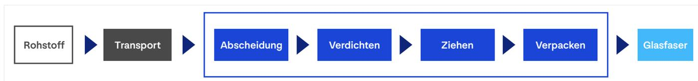
Abbildung 3. Prozessablauf der wesentlichen Fertigungsstufen der optischen Faser
