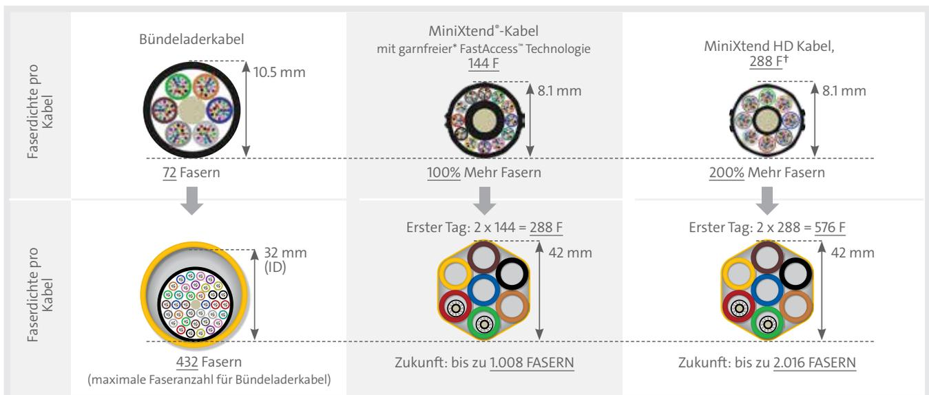
\*Corning's geschützte Innovation des garnfreien FastAccess Technologie bezieht sich auf die Kombination der FastAccess-Technik des Kabelmantels- die ein schnelleres und sicheres Öffnen des Mantels ermöglicht- und des Fertigungsprozesses, welcher die Notwendigkeit der Verwendung von Haltegarnen und quellfähigen Bändern überflüssig macht.
