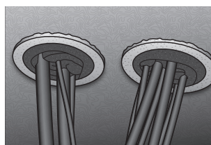
多数本のケーブルが入った管路の止水
