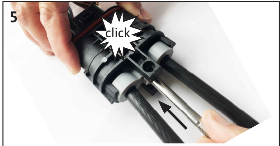
5 Push and press the spacers into the ECAM / Pousser et enfoncer les entretoises dans l'ECAM
