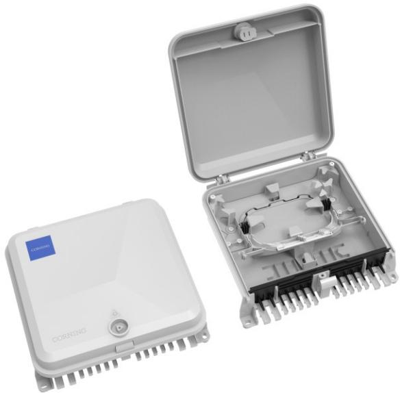
Ce Point d'Accès Optique (PAO) est proposé pour des applications de distribution aérienne. Ce terminal de distribution fait partie de la gamme PBO et peut connecter jusqu'à 10 câbles clients/drops, 1 câble de distribution et 2 câbles de distribution secondaire. L'organiseur est compatible avec des fibres G.652.D et G.657, loose tubes et micromodules. Il peut être équipé avec des cassettes standard de la gamme BPEO. L'organiseur peut recevoir des cassettes 1-pas (5 mm) ou 2-pas (10 mm).
