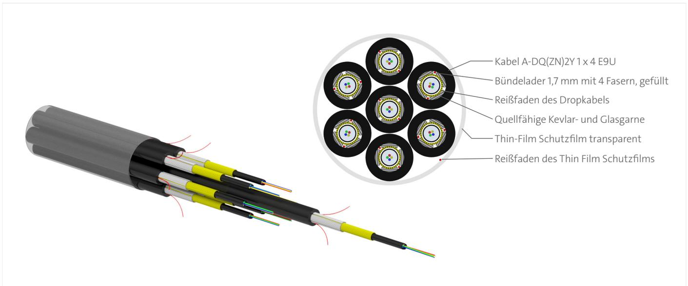
Schematische Darstellung: TFBD 7x A-DQ(ZN)2Y 1 x 4 E9U/125 0,34F3,5 + 0,20H
