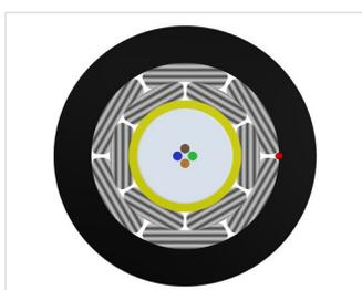
Câble extérieur à tube central armé diélectrique
