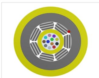
Câble FREEDM à tube central avec gel, intérieur/extérieur, armé diélectrique
