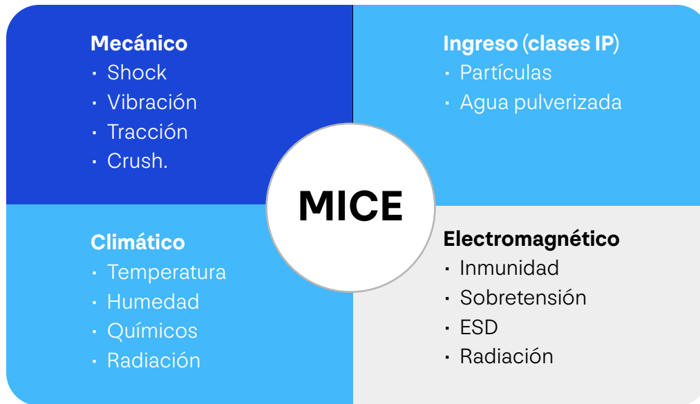
Figura 1: Descripción general del sistema de clasificación ISO/IEC 11801/EN 50173/TIA-568 para evaluar la robustez ambiental de sistemas de cableado y componentes en entornos industriales. Fuente: Corning Fuente: Corning
