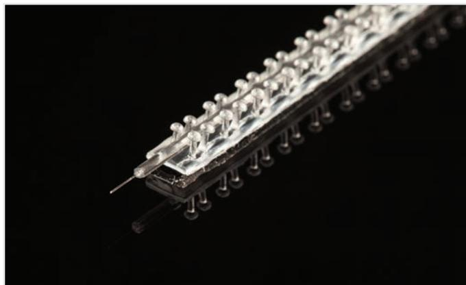
Figure 7. Gros plan sur le chemin transparent. La fibre transparente est maintenue en place par les éléments en forme de tentacules.
