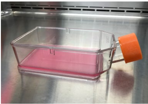
図 4. Elplasia 12K フラスコの培養ポジションでの推奨初期播種量 25 mL の培地によるマイクロキャビティ面の被覆状態。
