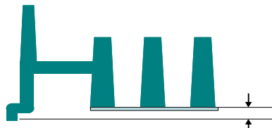
プレートボトムとウェルボトムの距離は 1.8 mm
