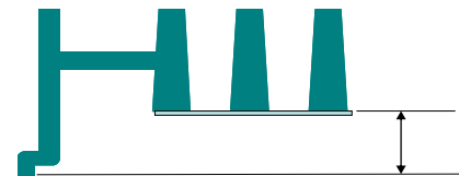
プレートボトムとウェルボトムの距離は 5.6 mm
