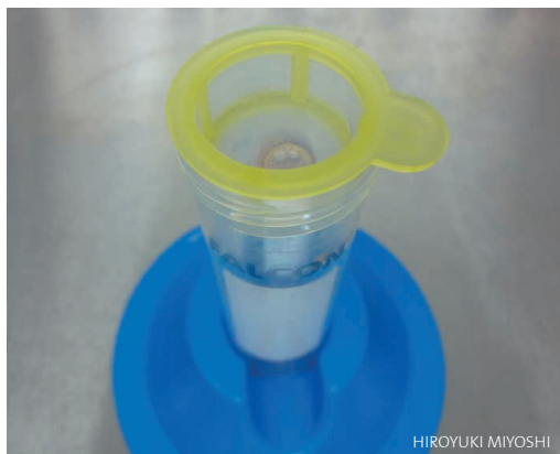
写真5 セルストレーナーを用いて大きなデブリや組織片を除く
