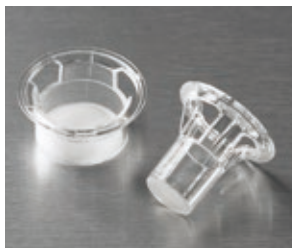
24 mmと6.5 mmトランズウェルインサート
