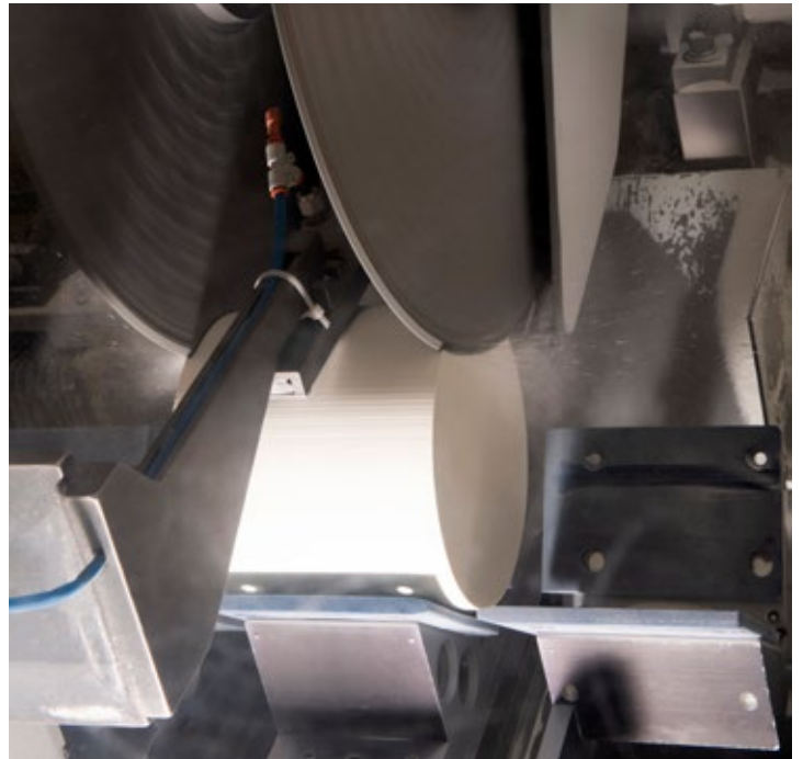
鋸切汽車排放控制用的陶瓷。其粉塵可以回收利用以減少垃圾掩埋。
