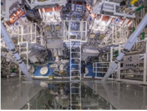
國家點火設施的靶室，是由192道雷射光束將超過200萬焦耳的紫外線能量，傳輸到一個微小的燃料顆粒，以產生核融合反應點火的地方。
