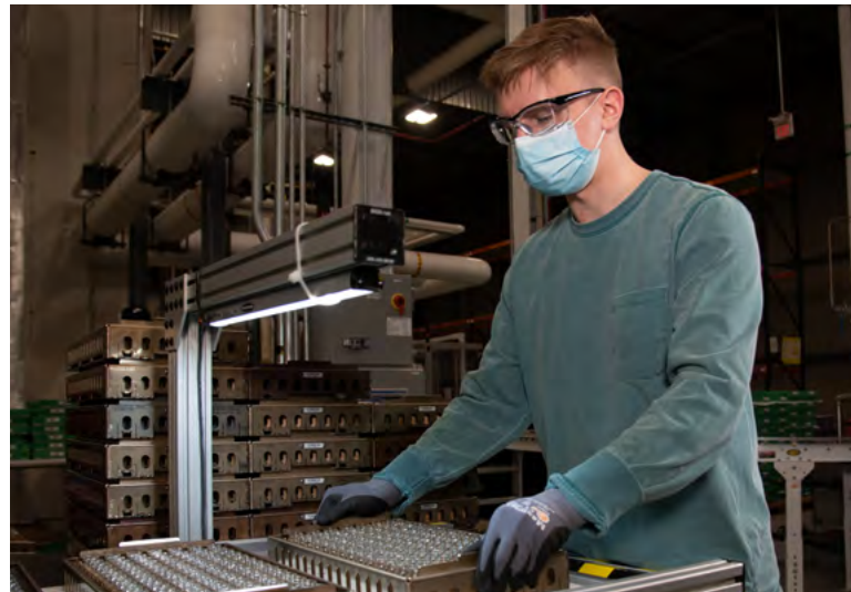
康宁医药科技的一名员工正在装载注射剂瓶, 准备进行离子交换流程。
