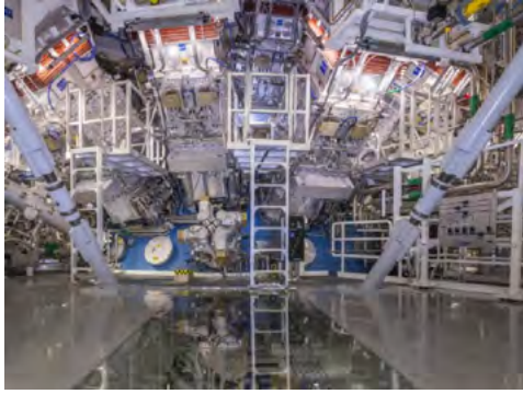
LLNL国家点火装置的靶室，其中192束激光将超过200万焦耳的紫外线能量传送到一个微小的燃料靶上，以产生聚变点火。
